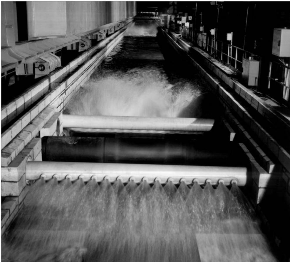
Устройство для предварительной обработки на линии протравливания
